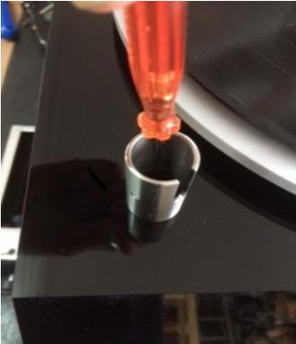
Entfernen Sie die Gummikappe in dem Aufsatzrohr mit einem kleinen Schraubendreher.
