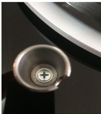
Entfernen Sie mittels Kreuzschlitzschraubendreher die Kreuzschlitzschraube. ( links herum lösen )
