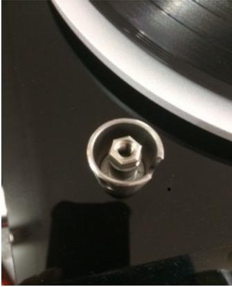
Richten Sie den Befestigungsbolzen so aus, dass er genau in der Mitte des Rohres platziert ist und ziehen Sie ihn fest.
